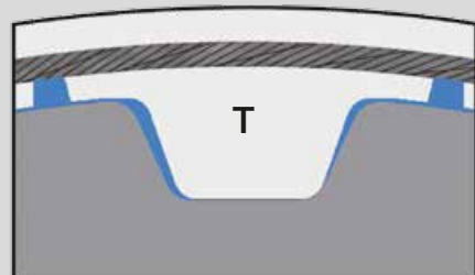
„SE“-Lücke, Reduzierte Lückenform Reduced Backlash „SE“ Tooth Gap
