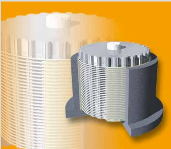
Gießform, dargestellt mit einem spiralförmig angeordneten Stahlcordzugträger auf dem Formkern
