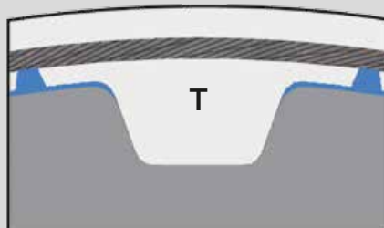
„0“-Lücke, Null-Lückenform Zero Backlash „0“ Tooth Gap
